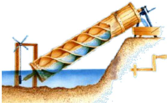
una certa quantità di sostanza che viene sollevata lungo la spirale fino ad uscire dalla parte superiore, dove viene scaricata in un bacino di accumulo. L'energia per la rotazione può essere fornita da una manovella, da animali, da eliche di mulini a vento o da trattori agricoli.
